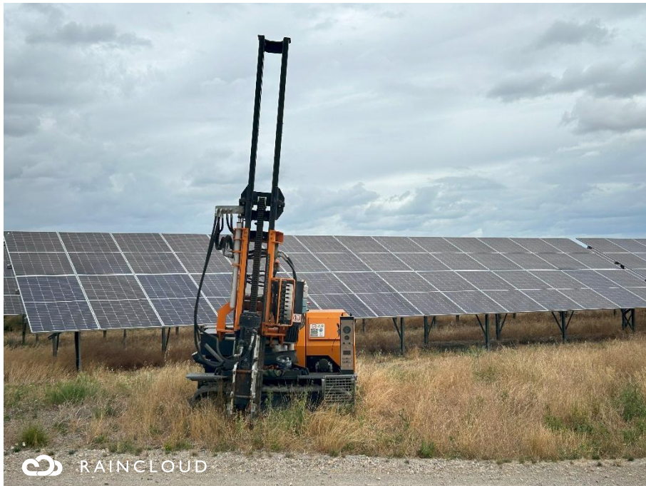
Plate 12-23 Mini pile driver examples
